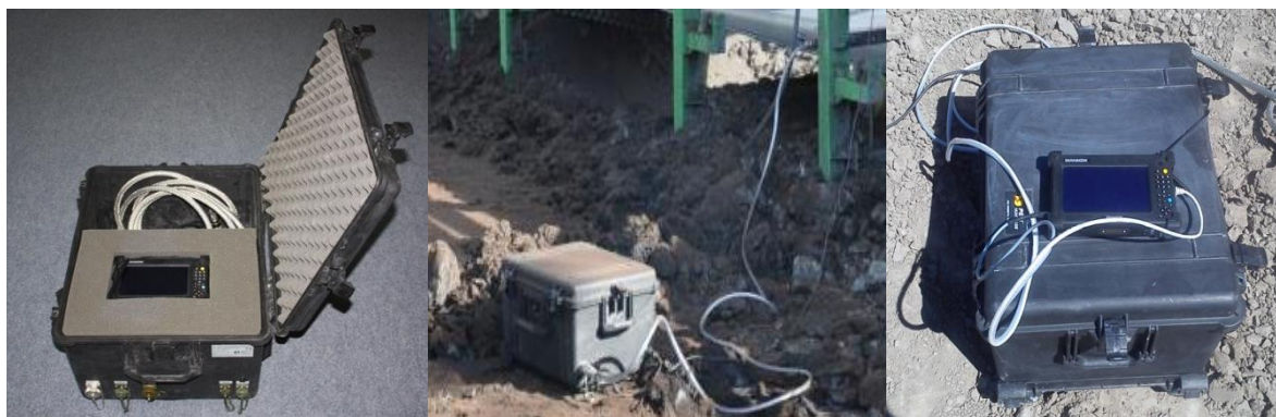
Rys.3. Widok skrzynki pomiarowej systemu z widocznym tabletem i okablowaniem oraz podczas pracy jej przy przenośniku
