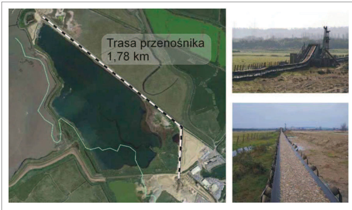
RYS. 1 Przykład zastosowania taśmociągu w transporcie żwiru (Cliffe Pools, Wielka Brytania)
